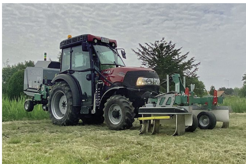
Die Electroherb-Technologie kontrolliert den Unterbewuchs mit Strom.
